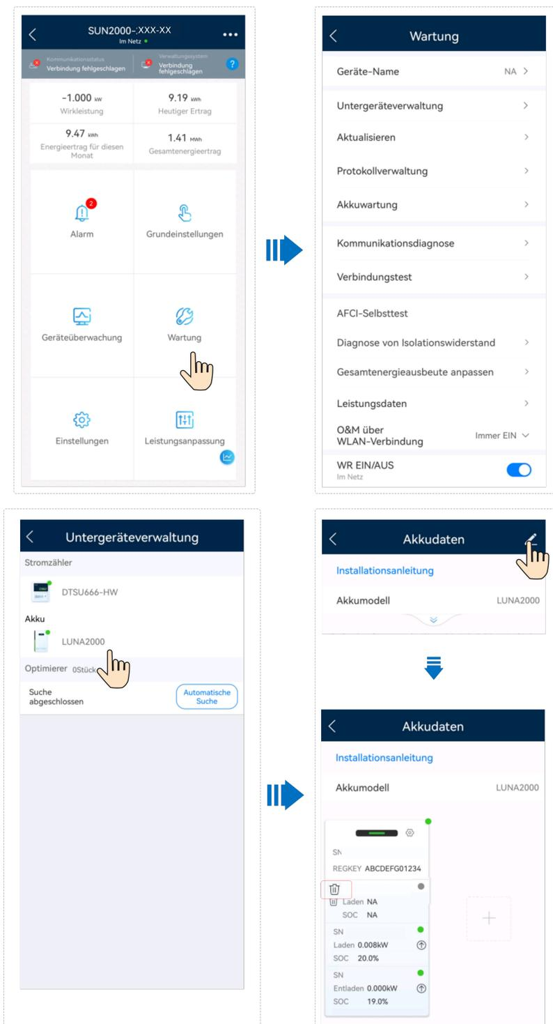
Wenn die EMMA für die Vernetzung verwendet wird, **verbinden Sie die EMMA mit der App**, tippen Sie auf dem Startbildschirm auf **Geräteüberwachung**, wählen Sie den angeschlossenen Wechselrichter, wählen Sie **Wartung > Untergeräteverwaltung**, tippen Sie auf das ESS-Symbol und löschen Sie das Offline-Energiespeichermodul.
