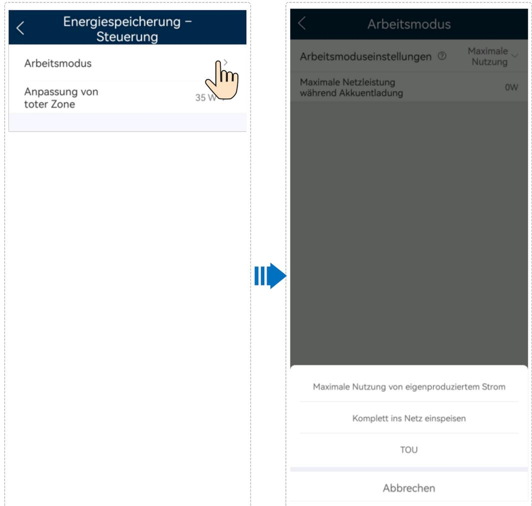
**Verbinden der EMMA mit der App.** Tippen Sie auf dem Startbildschirm auf **Geräteüberwachung**, tippen Sie auf den entsprechenden Wechselrichter, tippen Sie auf **Festlegen** und stellen Sie die entsprechenden Parameter ein.
