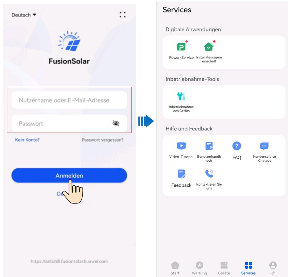
**Schritt 2** Stellen Sie eine Verbindung zum WLAN der EMMA her und melden Sie sich als **Installateur** an, um auf den Bildschirm „Inbetriebnahme des Geräts“ zuzugreifen.
