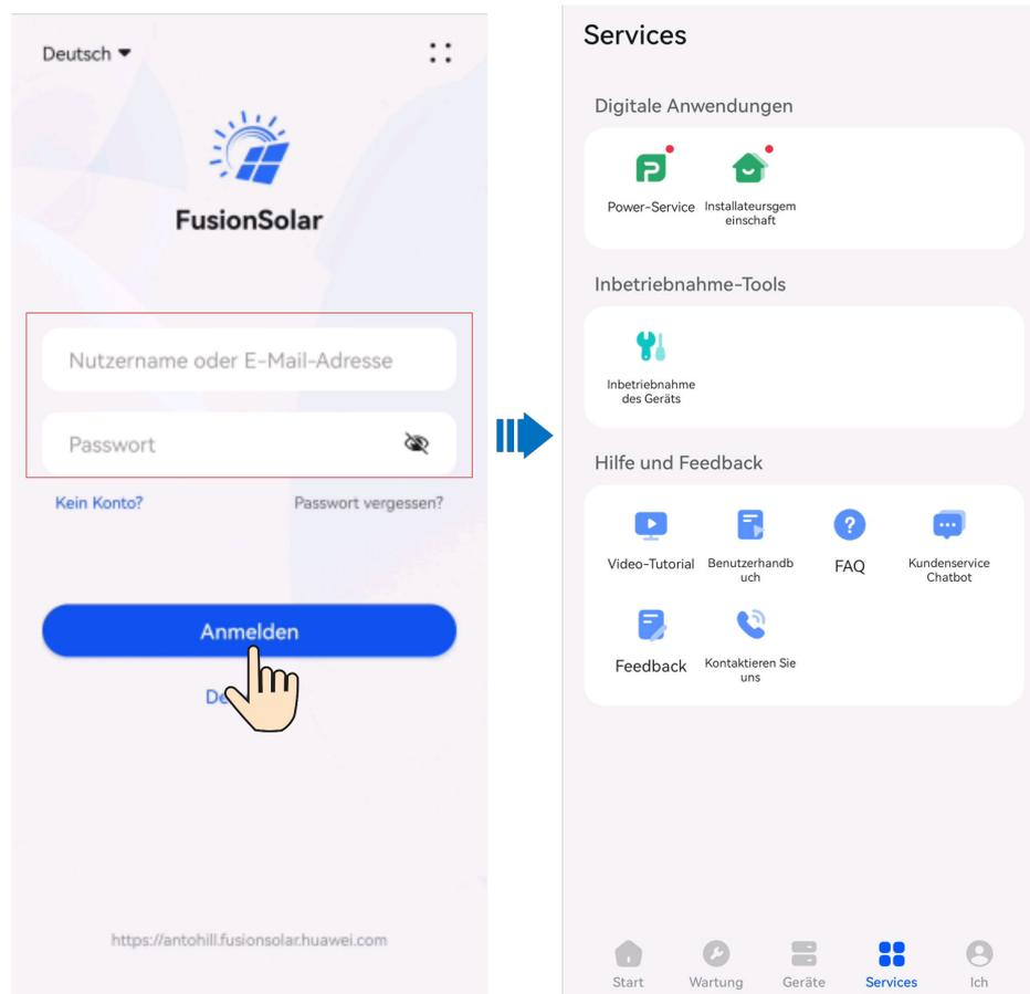
**Schritt 2** Stellen Sie eine Verbindung zum WLAN des Wechselrichters her und melden Sie sich als **Installateur** an, um auf den Bildschirm „Inbetriebnahme des Geräts“ zuzugreifen.
