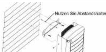
5. Hängen Sie den Wechselrichter auf die Halterung (siehe *Abbildung 9*): Heben Sie den Wechselrichter seitlich, oder halten Sie ihn unten und oben fest, um das Gerät in die Halterung einzuhängen.
