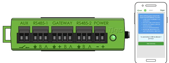
Verwenden Sie die Tigo SMART App, um die Internetverbindung zu konfigurieren (kabelgebundenes Ethernet oder WLAN). Wählen Sie in der App Discovery starten, um mit dem Scannen der TS4-Einheiten zu beginnen. Die Erkennung sollte vor Ort von der Tigo SMART App aus initiiert werden während die direkte Verbindung mit dem CCA besteht. Nach der Inbetriebnahme deaktivieren Sie das System durch Ausschalten der CCA und des Wechselrichters.
