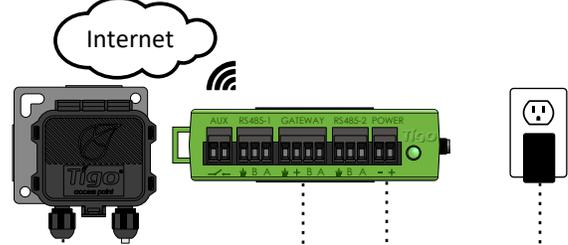
Der Cloud Connect Advanced (CCA) benötigt Wechselstrom, eine Internetverbindung (Ethernet oder Wi-Fi) und eine RS485 - Kommunikationskabelverbindung zum TAP(s).
