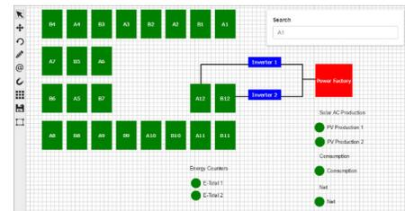
Um einen Lageplan des Systems zu erstellen, die dem physikalischen Layout \* entspricht, verwende die abziehbaren Aufkleber von den TS4 oder speichere die Barcodes auf erstelle damit eine Karte, die ihren physikalischen Standort darstellt.
