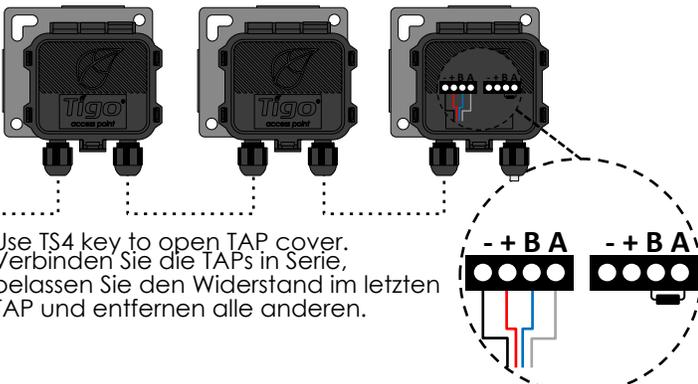
Use TS4 key to open TAP cover. Verbinden Sie die TAPs in Serie, belassen Sie den Widerstand im letzten TAP und entfernen alle anderen.
