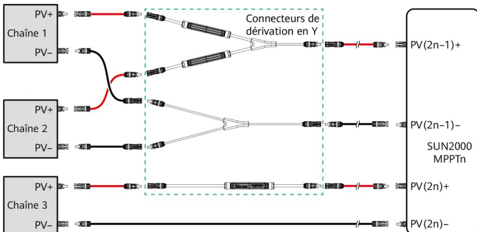
**Connexion des connecteurs de dérivation en Y à l'onduleur solaire à une distance de sécurité (recommandé)**
