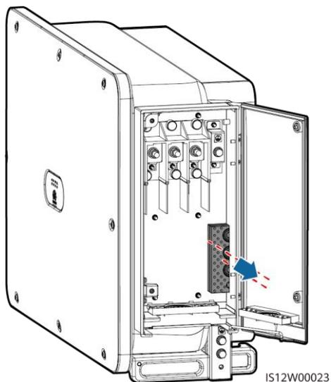
4. Sélectionnez un module de sertissage en fonction du type de câble d'alimentation de sortie CA.
